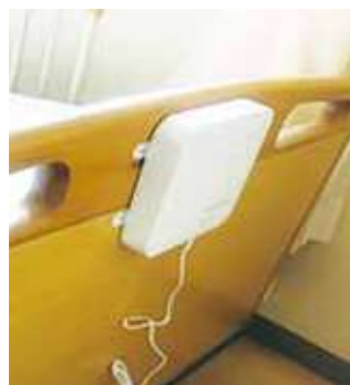
バイタルセンサーの設置状況
