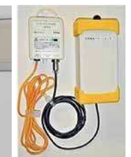
ナースコールシステムへの接続例
