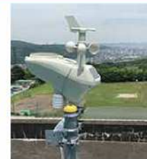
大分県大分市で設置された気象センサーとカメラの設置状況
